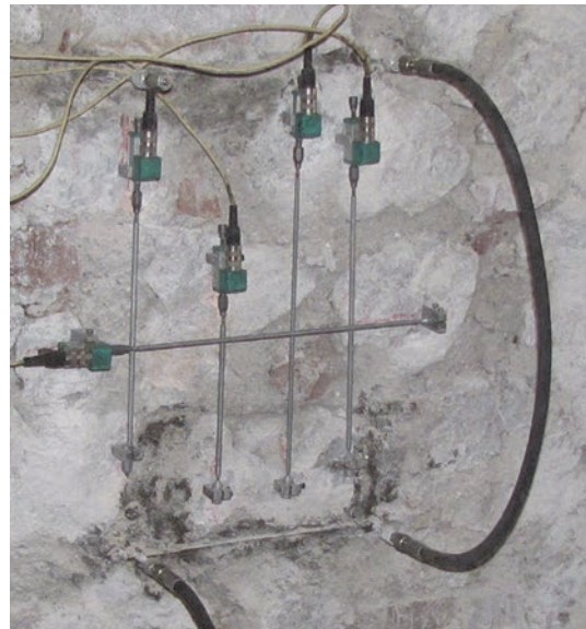
Slika 6. Postav ispitivanja pomoću dvostrukog tlačnog jastuka
