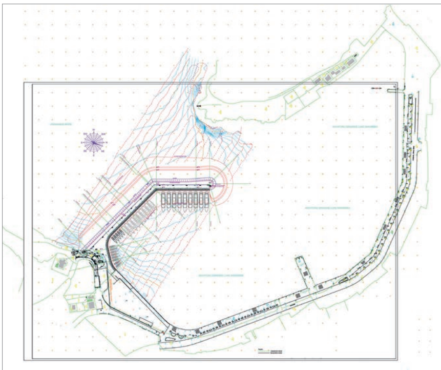
Situacija nadzemnih dijelova lukobrana (iz projektne dokumentacije)
