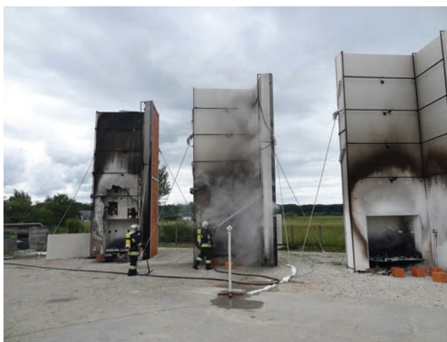
Četrdeset minuta nakon izbijanja požara neki uzorci još gore i stvaraju otrovni plin, ali vatra nije vidljiva i na nekim se uzorcima sama ugasila
