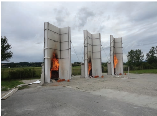
Početak testiranja kada su istodobno zapaljena ložišta što simuliraju požar u stanu
