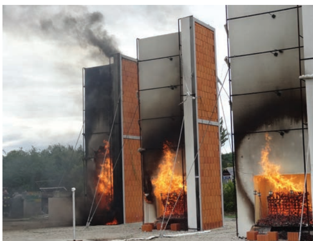
Nakon početka izbijanja požara uzorci su potpuno zahvaćeni vatrom i stvaraju veliku količinu otrovnog dima i plinova
