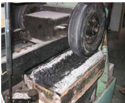
Ispitivanje otpornosti na zamor materijala: uobičajeni materijal nakon 100 ciklusa na 60 °C (lijevo), novi Polyflex Advanced PU nakon 30.000 ciklusa na 60 °C (desno)
