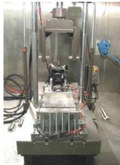
Ispitivanje kapaciteta pomicanja na BAM-u u Berlinu
