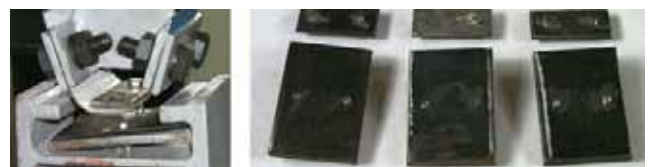
Slika 19. Lom samoreznih vijaka opterećenih na vlak
