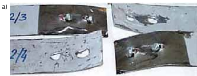
Slika 12. Lom savijanjem lima kod spojeva na preklop
