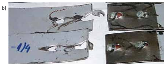
Slika 13. Probijanje glave vijaka a) veliki krajnji razmak, b) mali krajnji razmak
