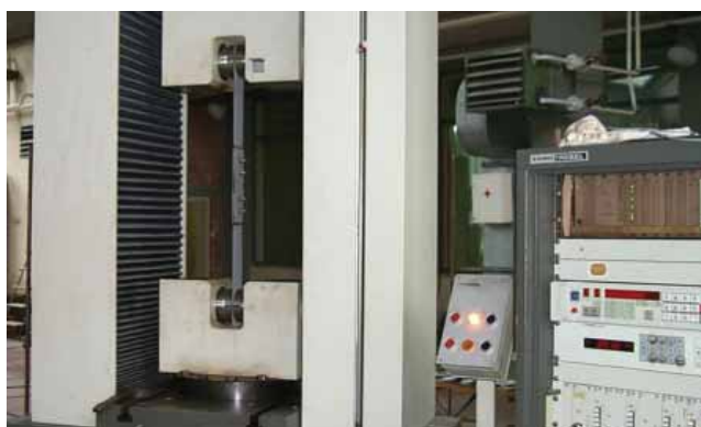
Slika 5. Elektronska kidalica RM400 nosivosti 400 kN
