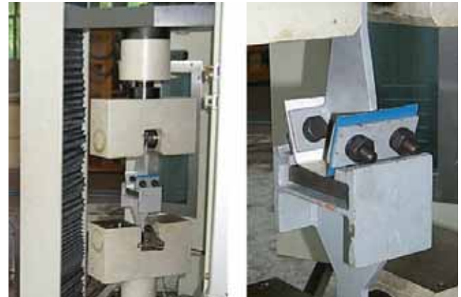
Slika 16. Ispitivanje uzoraka u spojevima opterećenim na vlak
