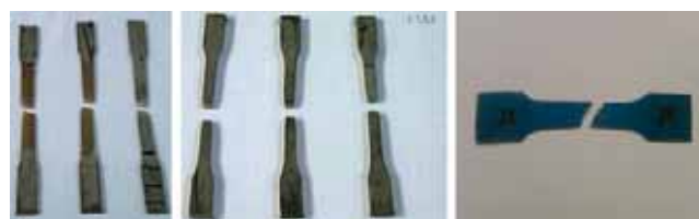
Slika 6. Ispitane epruvete od limova debljine 2 mm (T2-L), 4 mm (T4-L) i 0,85 mm (T1)
