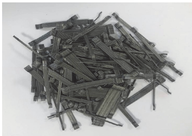
Slika 2. Čelična vlakna korištena u betonu
