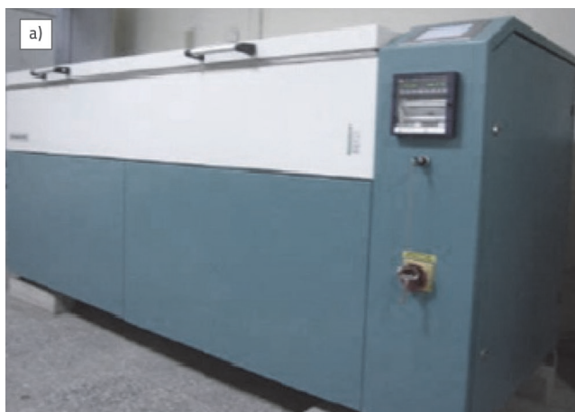
Slika 9. a) Uređaj za smrzavanje i odmrzavanje; b) vrijeme ciklusa
