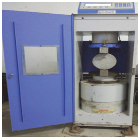
Slika 8. Ispitivanje vlačne čvrstoće cijepanjem
