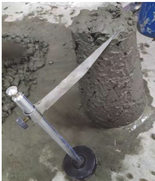
Slika 5. Ispitivanje slijeganja svježeg betona
