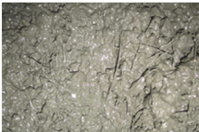
Slika 3. Svježja mješavina betona ojačanog čeličnim vlaknima
