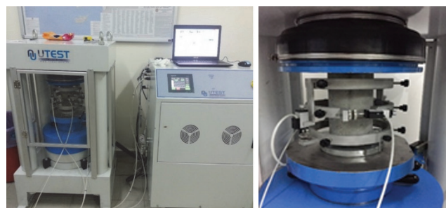
Slika 3. Preša za ispitivanje čvrstoće betona i kompresometar kojim se mjeri modul elastičnosti
