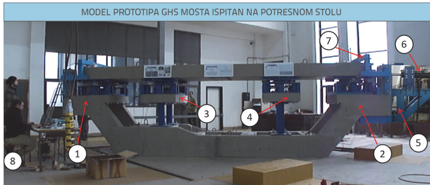
Slika 10. Model prototipa GHS mosta: (1) lijevi krajnji oslonac; (2) desni krajnji oslonac; (3) oslonac iznad kraćih stupova; (4) oslonac iznad viših stupova; (5) potporna konstrukcija pobuđivača; (6) pobuđivač; (7) oslonac za DL uređaje; (8) računalo koje kontrolira ciklična ispitivanja
