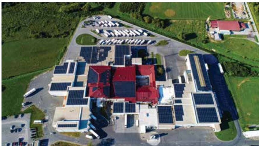
Pogled na industrijsko postrojenje u Karlovcu s instaliranom sunčanom elektranom površine 7500 m 2
