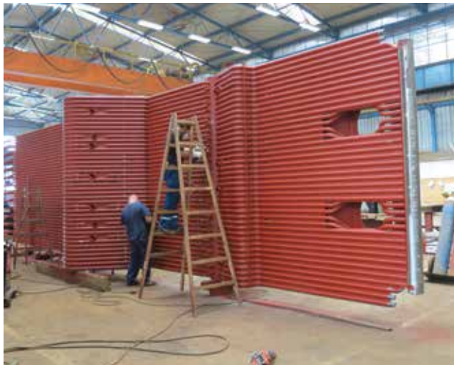
Pogled na zid kotla u radionici
