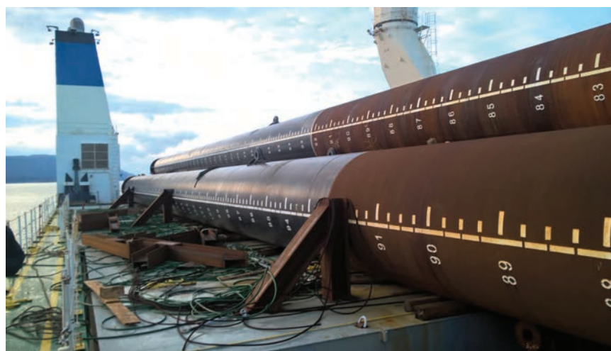
Čelični piloti snimljeni tijekom transporta na gradilište
