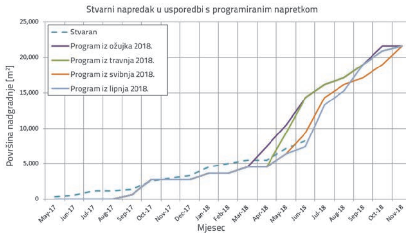
Slika 20. Praćenje stvarnog napretka radova na nadgrađu kesona te usporedba sa planiranim veličinama po mjesecima
