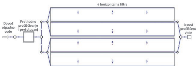
Slika 5. Konfiguracija biljnog uređaja za pročišćavanje otpadnih voda s horizontalnim filterima
