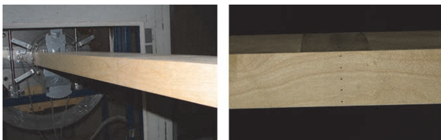
Slika 10. Model drvenoga poprečnog presjeka mosta u aerotunelu
