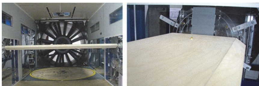
Slika 9. Model pravokutnoga poprečnog presjeka u aerotunelu
