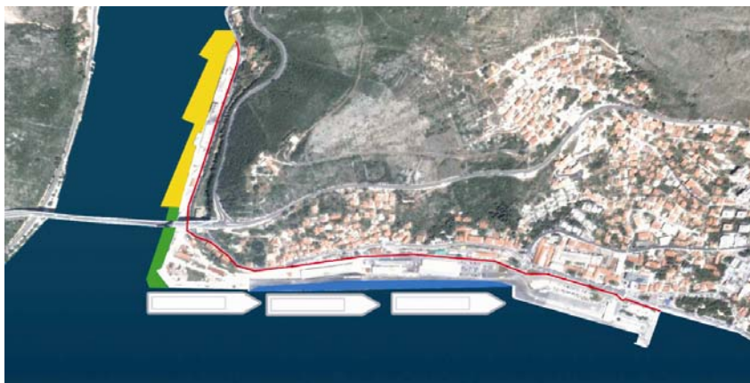
Prikaz nove dubrovačke luke u Gružu (plavo - izvedeno, zeleno - u izvođenju, žuto - u planovima)
