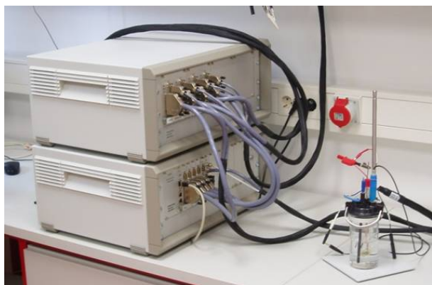
Slika 4. Sustav za elektrokemijska ispitivanja korozijske otpornosti
