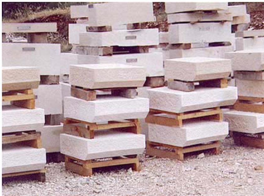
Isklesani kameni blokovi pripremljeni za ugradnju
